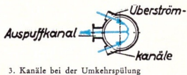
3. Kanäle bei der Umkehrspülung
